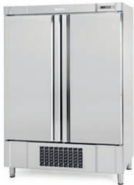
Infrico / Armario refrigeración mod. AN 1002 T/F Armario con dos puertas. Exterior e interior en acero inoxidable AISI 304. Respaldo en chapa galvanizada. Aislamiento de poliuretano inyectado de alta presión. Control de temperatura final de desescarche. Puertas con tirador integrado. Desagüe en el interior de la cámara. Dimensiones: 1385x700x2030 mm.
