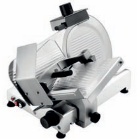
Sammic / Cortadora de fiambre mod. GC Construida en aleación de aluminio anodizado. Transmisión por correa. Conjunto afilador de cuchilla. Diámetro de la cuchilla 250 / 300 mm. Capacidad de corte 190x250 y 220x260 mm. respectivamente. Espesor de corte 0-15 mm. Potencia 300W.
