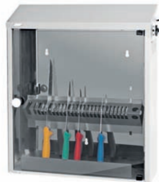
Sistema / Esterilizador de cuchillos mod. CHETO 050P Construido en acero inoxidable. Puerta de polímero transparente ahumada con cierre magnético e interruptor que corta la alimentación en el momento de la apertura. La radiación ultravioleta emitida por el tubo germicida ejerce una potente acción fotoquímica descontaminante. Minutero regulable de 0 a 2 horas. Para 15 cuchillos con soporte varilla de acero inoxidable.
