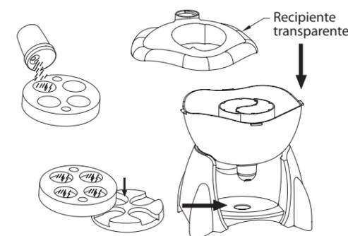
4. Ubique el obturador como lo muestra la figura y gírelo en la posición adecuada para que coincida con los orificios debajo del recipiente. Corte y ralle distintos sabores de chocolate en trozos pequeños con el cuchillo de plástico y viértalos en las 2 ranuras del recipiente por separado.
