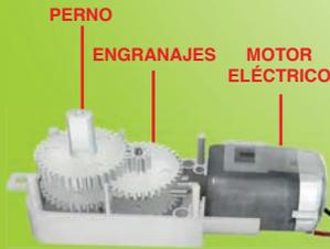
Como puedes ver en la imagen, los dos motores que hacen que tu robot se mueva están formados por dos partes distintas: el **motor eléctrico** propiamente dicho, y una caja con una serie de **engranajes**. Esta última sirve para reducir la velocidad de rotación de los motores, que, de no ser así, harían girar las ruedas demasiado rápido. Los dos motores del kit están conectados a un conector Molex, que permite la conexión con la placa de circuitos.
