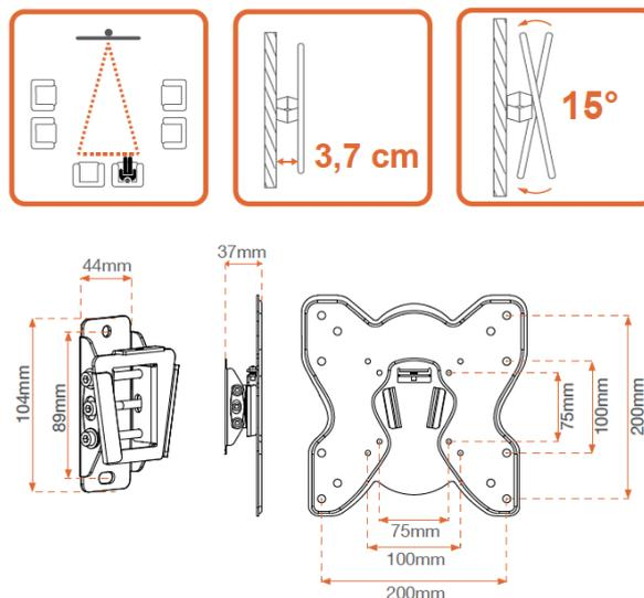
Este soporte permite fijar los TV LED de 71 a 106cm a la pared y así poder suprimir el mueble del TV o liberar espacio para colocar otros aparatos multimedia. Espacio entre el TV y la pared: 3,7cm
