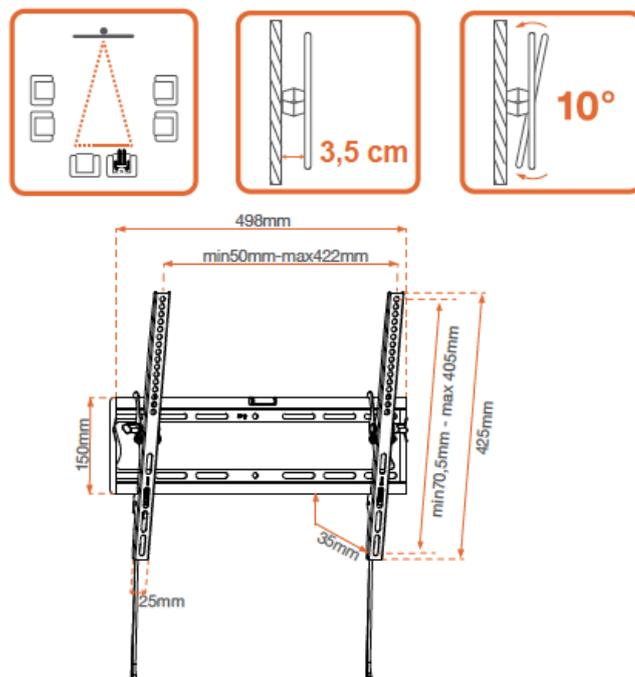
Este soporte permite fijar los TV LED de 106 a 140cm a la pared y así poder suprimir el mueble del TV o liberar espacio para colocar otros aparatos multimedia. Espacio entre el TV y la pared: 3,5cm para una fijación casi invisible. La inclinación de 10° hacia abajo asegura buena visibilidad. Fácil de instalar, nivel con burbuja integrado.
