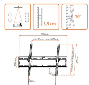
Este soporte permite fijar los TV LED de 106 a 140cm a la pared y así poder suprimir el mueble del TV o liberar espacio para colocar otros aparatos multimedia. Espacio entre el TV y la pared: 3,5cm para una fijación casi invisible. La inclinación de 10º hacia abajo asegura buena visibilidad. Fácil de instalar, nivel con burbuja integrado.
