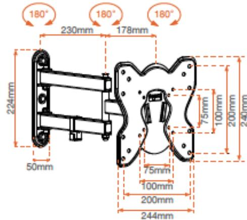
Este soporte permite fijar los TV LED de 71 a 106cm a la pared y así poder suprimir el mueble del TV o liberar espacio para colocar otros aparatos multimedia. Gracias al brazo de desplazamiento de 40cm máximo, la rotación de 180° y la inclinación de 3° hacia arriba y 12° hacia abajo, puede ajustar su TV para conservar una buena visibilidad en cualquier posición
