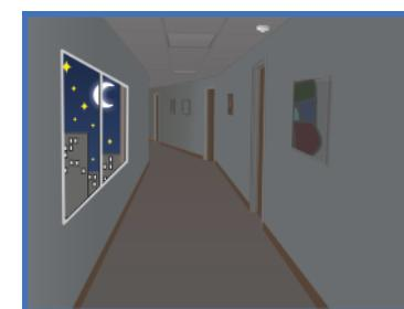
Cuando no hay suficiente luz ambiental, el detector se activa. Sin detección, la lámpara permanece apagada todo el tiempo.
