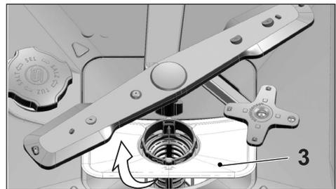
3. Pulse los dos trinquetes del filtro grueso hacia adentro y separe el filtro grueso del montaje.
