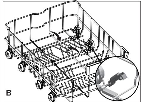
**i** Puede que las púas se doblen si las coge de los extremos. Por lo tanto, será necesario poner las púas del medio en posición vertical y horizontal cogiéndolas del tronco y pulsándolas en la dirección de la flecha.
