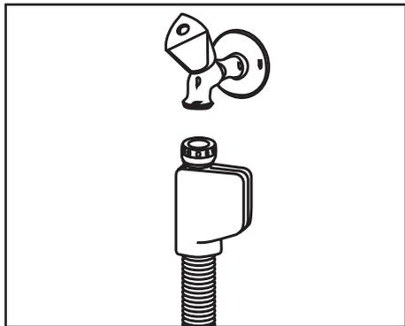
⚠ Dado que el juego de tubos contiene conexiones eléctricas y juntas, nunca acorte o alargue el tubo con tubos de extensión.
