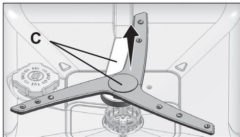
Para retirar y limpiar el conjunto del impulsor inferior, sosténgalo con una mano de los puntos (C) mostrados en la figura y tire hacia arriba para retirarlo. Después de la limpieza, siga estos pasos en orden inverso para reinstalar el conjunto del impulsor.
