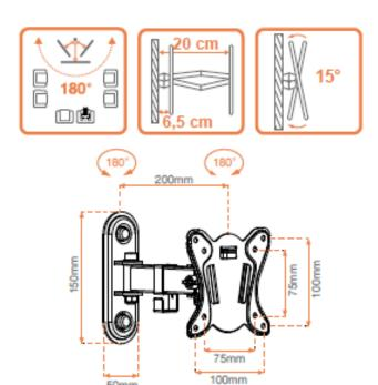
Este soporte permite fijar los TV LED de 33 a 71cm a la pared y así poder suprimir el mueble del TV o liberar espacio para colocar otros aparatos multimedia. Gracias al brazo de desplazamiento de 20cm máximo, la rotación de 180° y la inclinación de 3° hacia arriba y 12° hacia abajo, puede ajustar su TV para conservar una buena visibilidad en cualquier posición
