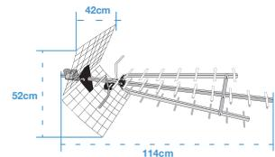
Esta antena triple activa tiene un ancho de banda adaptado al nuevo standard UHF (ancho de banda más corto). Permite la recepción de señales TDT reduciendo las perturbaciones asociadas al 4G.
