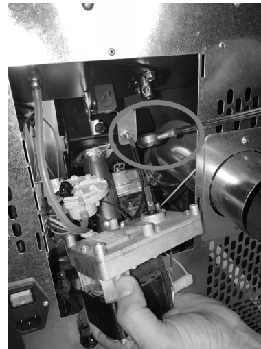
Fig. 46 - Extracción del motorreductor
