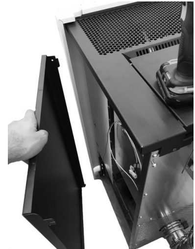
Fig. 36 - Extracción de los laterales
