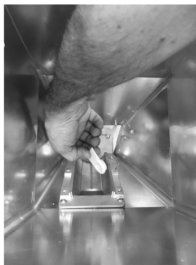
Fig. 48 - Extracción del cojinete
