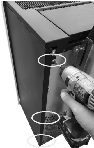
Fig. 34 - Afloje los tornillos
