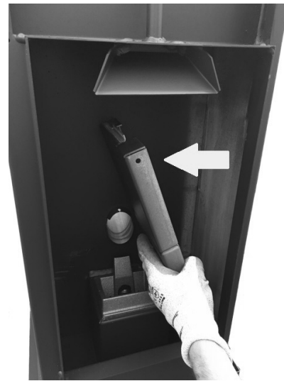
Fig. 52 - Retirada del tiro derecho
