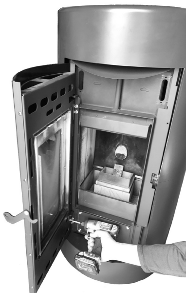
Fig. 63 - Desmontaje de la puerta
