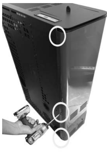
Fig. 44 - Extracción de los tornillos 4
