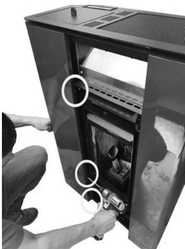
Fig. 43 - Extracción de los tornillos 3
