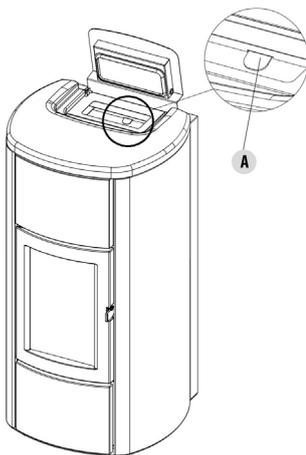
**Fig. 20 - Palanca para la limpieza de los dispositivos de turbulencia (Idro Prince<sup>3</sup> 16-23-23 H2O, Aquos<sup>3</sup> 16-23-23 H2O, Idron 16-22 Airtight, Hydrofire 22.8)**
