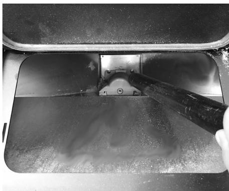
*Fig. 17 - Limpieza depósito*
