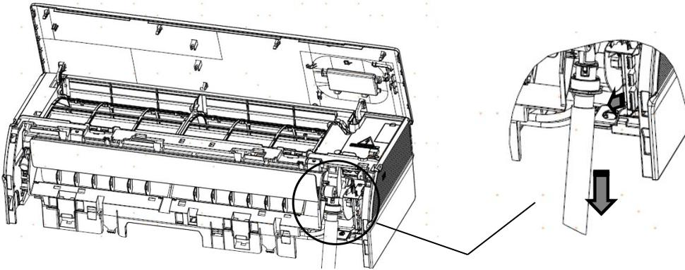
4. Abrir la pestaña inferior "A" hasta este ángulo y luego abrir la pestaña "B" para retirar el ventilador de flujo cruzado y el motor.
