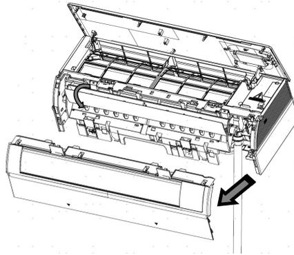
3. Desconectar la manguera de desagüe y los terminales.
