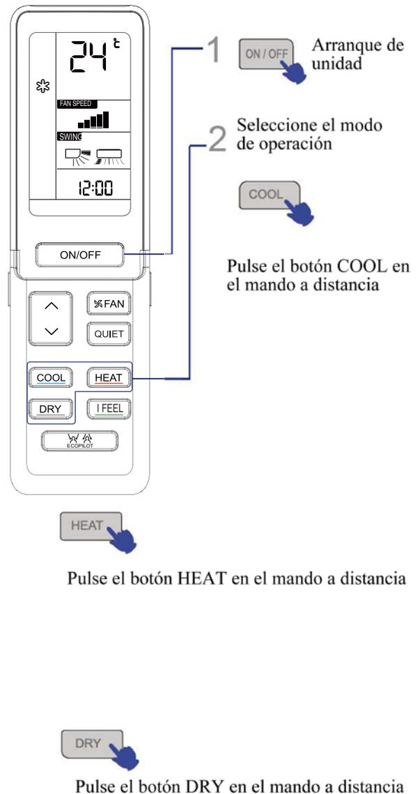
1. En el modo DRY, cuando la temperatura interior sea +2°C menor que la temperatura configurada, la unidad funcionará intermitentemente a velocidad LOW independientemente del ajuste de FAN.
