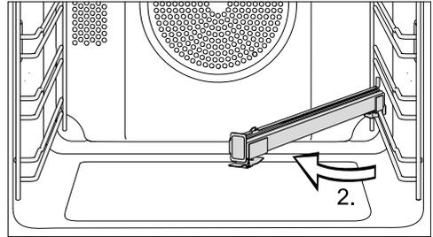
■ Abata la guía FlexiClip en el centro del interior del horno (2.).
