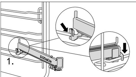
■ Encaje la guía telescópica FlexiClip en la parte delantera del listón superior de un nivel (1.).
