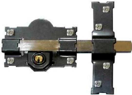
Se trata de un dispositivo metálico de uso fundamentalmente residencial, de instalación tanto en interior, como en exterior, que se fija en las puertas y que su función principal es mantenerlas cerradas, compuesto fundamentalmente por una barra de acero con un tirador) montada en un soporte (placa). El cierre se efectúa al introducir la barra en el cerradero, colocado éste en el marco de la puerta.
