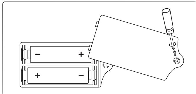
A colocação das pilhas deve ser feita por um adulto. Desligue a trotinete antes de colocar as pilhas. Com uma chave de fendas (não incluída), remova o parafuso e abra a tampa das pilhas na parte inferior da trotinete. Insira / substitua as pilhas na unidade, com a polaridade indicada no compartimento das pilhas. Volte a colocar a tampa do compartimento das pilhas com o parafuso e a chave de fendas.
