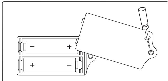
El cambio de pilas debe realizarlo un adulto. Apaga el juguete antes de poner las pilas. Afloja el tornillo con la ayuda de un destornillador de punta de estrella (no incluido) para abrir el compartimento de las pilas situado en la parte inferior del patinete. Coloca / sustituye las pilas en el compartimento dedicado a tal efecto y respetando el esquema de polaridad que se indica en la ilustración. Cierra el compartimento y atorníllalo de nuevo.
