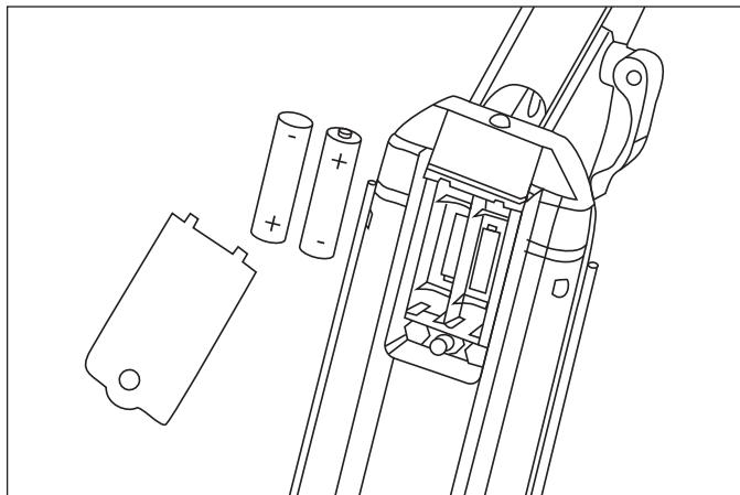
El cambio de pilas debe realizarlo un adulto. Apaga el juguete antes de poner las pilas. Afloja el tornillo con la ayuda de un destornillador de punta de estrella (no incluido) para abrir el compartimento de las pilas situado en la parte inferior del patinete. Coloca / sustituye las pilas en el compartimento dedicado a tal efecto y respetando el esquema de polaridad que se indica en la ilustración. Cierra el compartimento y atorníllalo de nuevo.
