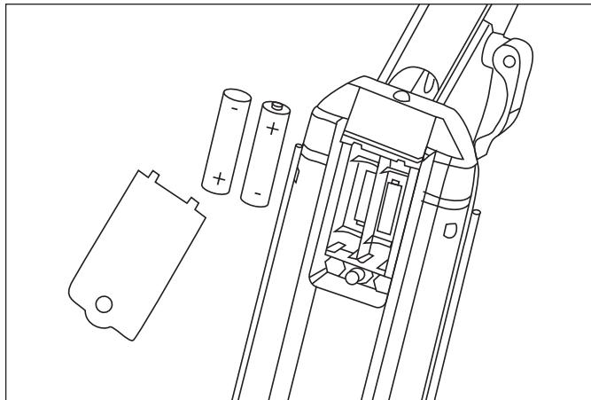
A colocação das pilhas deve ser feita por um adulto. Desligue a trotinete antes de colocar as pilhas. Com uma chave de fendas [não incluída], remova o parafuso e abra a tampa das pilhas na parte inferior da trotinete. Insira / substitua as pilhas na unidade, com a polaridade indicada no compartimento das pilhas. Volte a colocar a tampa do compartimento das pilhas com o parafuso e a chave de fendas.
