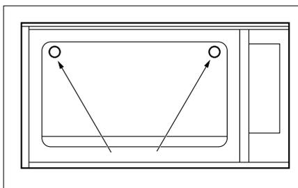
**IMPORTANTE:** La targhetta delle caratteristiche del forno è accessibile anche ad apparecchio installato. In questa targhetta, visibile aprendo la porta, sono riportati tutti i dati di identificazione dell'apparecchio a cui si dovrà fare riferimento per richiesta di ricambi.
