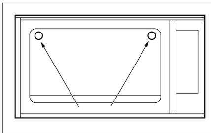
**IMPORTANT:** Plăcuța de date a cuptorului este accesibilă chiar și atunci când cuptorul este complet instalat. Plăcuța de date este vizibilă prin simpla deschidere a ușii. Comunicați întotdeauna informațiile de pe aceasta pentru a identifica aparatul atunci când comandați piese de schimb.
