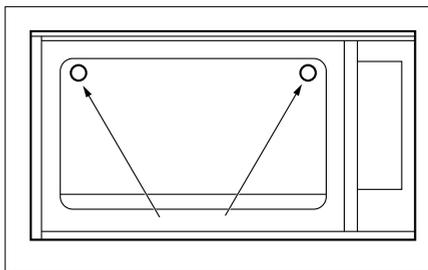
**IMPORTANTE:** La placa de características del horno se encuentra disponible junto con el aparato. En esta placa, visible abriendo la puerta, se muestran todos los datos de identificación del aparato a los que se deberá hacer referencia para el pedido de piezas de repuesto.
