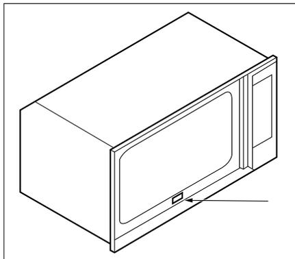
**IMPORTANT :** Il est possible d'accéder à la plaque des caractéristiques du four même lorsque l'appareil est installé. Cette plaque, que l'on voit en ouvrant la porte, présente toutes les données d'identification de l'appareil qu'il est nécessaire de citer pour toute demande de pièces de rechange.
