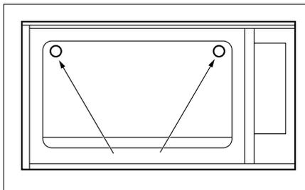
**WICHTIG:** Das Typenschild mit den technischen Merkmalen des Backofens ist auch bei installiertem Gerät zugänglich. Auf diesem Typenschild, das bei Öffnen der Ofentür sichtbar ist, sind auch alle Kenndaten des Geräts aufgeführt, die bei eventuellen Ersatzteilbestellungen angegeben werden müssen.
