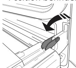
2. Die Tür so weit wie möglich schließen. Die Tür mit beiden Händen festhalten – diese nicht am Griff festhalten. Die Tür einfach entfernen, indem sie weiter geschlossen und gleichzeitig nach oben (a) gezogen wird, bis sie sich aus ihrem Sitz löst (b).
