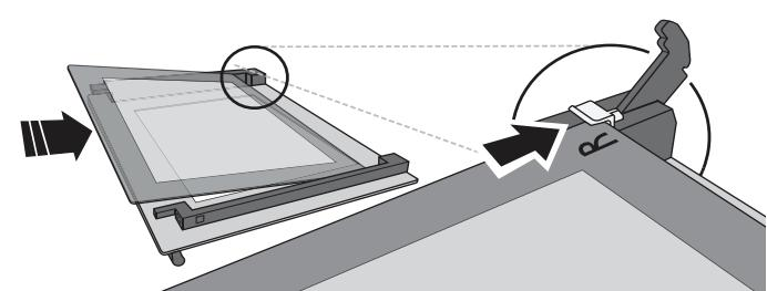
4. Επανατοποθετήστε την άνω γωνία: ένα κλικ δείχνει ότι τοποθετήθηκε σωστά. Βεβαιωθείτε ότι η τσιμούχα είναι καλά σταθεροποιημένη πριν επανατοποθετήσετε την πόρτα.
