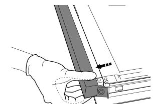
2. Ridicați și țineți ferm cu ambele mâini geamul interior, demontați-l și amplasați-l pe o suprafață moale înainte de a-l curăța.
