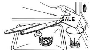
Para que el sistema de ablandamiento del agua pueda funcionar sin problemas, el aparato lleva a cabo un ciclo de regeneración del sistema a intervalos regulares. El proceso de regeneración está compuesto por varias fases. Empieza al final del último ciclo de enjuague, una vez alcanzada la cantidad de agua indicada en la regulación de la dureza del agua de red durante el ciclo de lavado, y termina al principio del siguiente ciclo de lavado.
