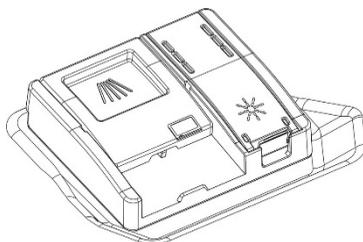
El abrillantador acelera el secado de la vajilla y previene la formación de manchas y depósitos calcáreos; la máquina añade el producto de forma automática durante el último ciclo de aclarado, tomándolo desde el depósito correspondiente, situado en la parte interna de la puerta.
