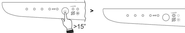
Tras la regulación o la visualización del programa configurado, basta dejar inactivo el botón durante algunos segundos: el lavavajillas regresa automáticamente a su condición estándar saliendo del modo de regulación.
