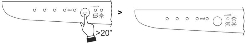
Tras la regulación o la visualización del programa configurado, basta dejar inactivo el botón durante algunos segundos: el lavavajillas regresa automáticamente a su condición estándar saliendo del modo de regulación.
