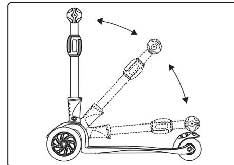
Puxe a parte baixa da barra da direção para cima e eleve-a. Para fechar a trotinete, puxe novamente a barra e, de seguida, aproxime-a do eixo até que fique bloqueada.
