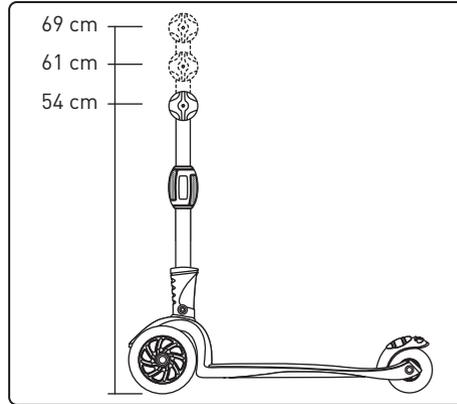
Desenrosca la pieza ovalada situada en el medio de la barra de dirección y sube el manillar hasta que haga clic en la altura deseada. Enrosca de nuevo la pieza ovalada para fijar la posición. Si quieres bajar el manillar o colocarlo a una altura diferente, desenrosca la pieza, aprieta el saliente metálico, mueve la posición de la barra y enrosca la pieza ovalada de nuevo.
