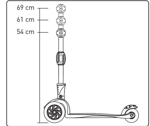
Desenrosque a peça ovalada situada no meio da barra de direção e suba o guiador até ouvir um clique na altura pretendida. Volte a enroscar a peça ovalada para fixar a posição. Se quiser baixar o guiador ou posicioná-lo numa altura diferente, desenrosque a peça, aperte a saliência metálica, mude a posição da barra e volte a enroscar a peça ovalada.
