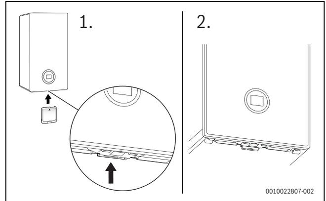
Fig. 3 Posición de la ranura de conexión Key
