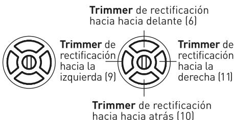
Si el dron se inclina hacia delante, pulsa el trimmer de abajo. Si se inclina hacia atrás, pulsa el trimmer de arriba.
