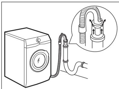
**i** El extremo de la manguera de desagüe siempre debe estar ventilado; es decir, el diámetro interno del tubo de desagüe (mín. 38 mm - mín. 1,5") debe ser mayor que el diámetro externo de la manguera de desagüe.
