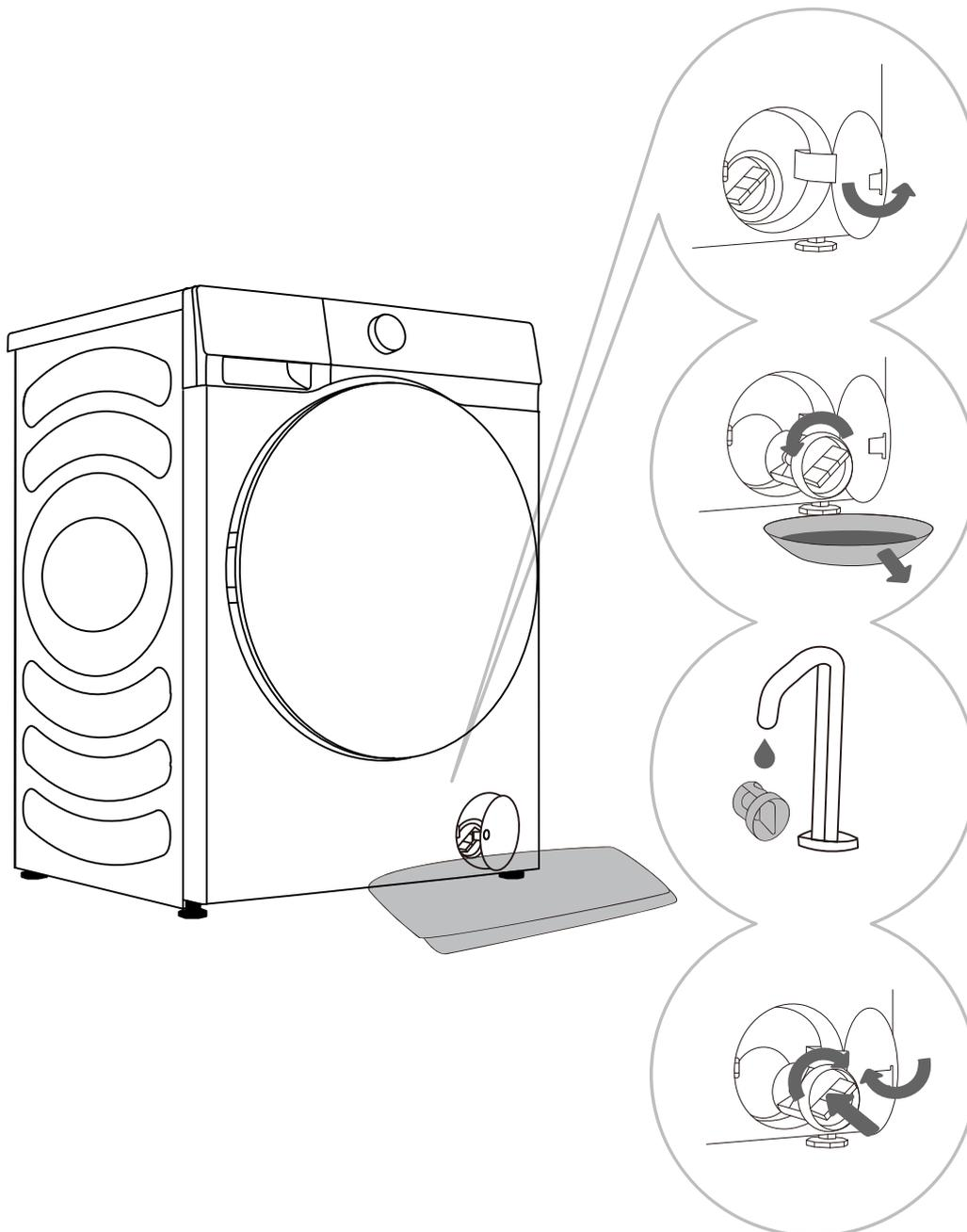
**1** Abra la cubierta del filtro de la bomba con una herramienta adecuada (presione la cubierta de la puerta y se abrirá automáticamente).
