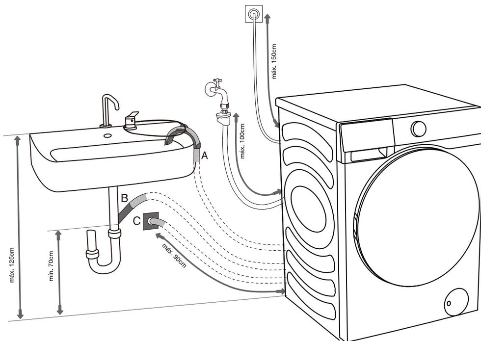
**A** El extremo de la manguera de descarga puede colocarse sobre un lavabo o una bañera. B Utilice un cordel introducido por la abertura del soporte acodado para fijar la manguera y evitar que se deslice hasta el suelo.
