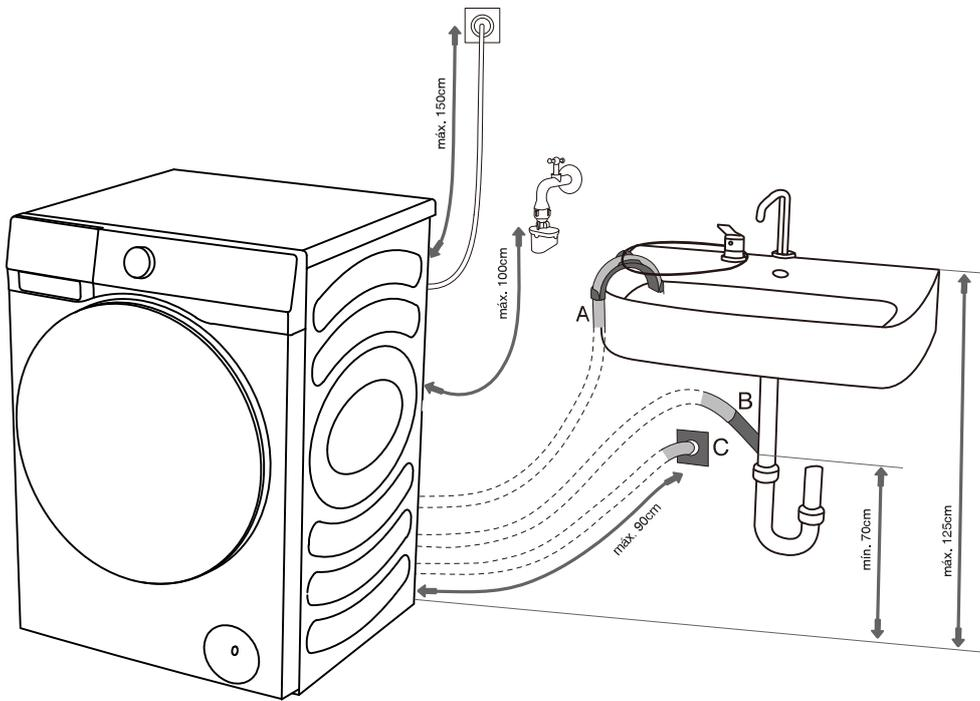
**C** La manguera de descarga también se puede conectar a un desagüe de pared con sifón; dicho sifón debe estar correctamente instalado para permitir la limpieza.
