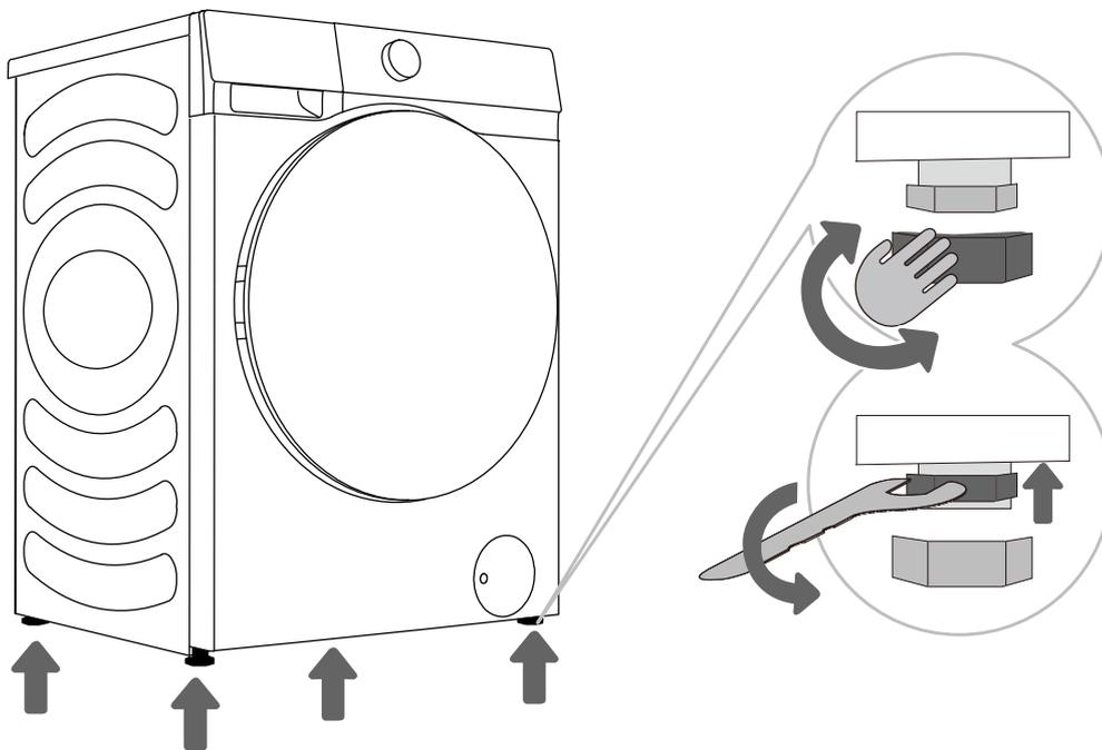
**1** Gire las patas ajustables para nivelar la lavadora longitudinal y transversalmente. Las patas pueden nivelarse +/- 2cm.
