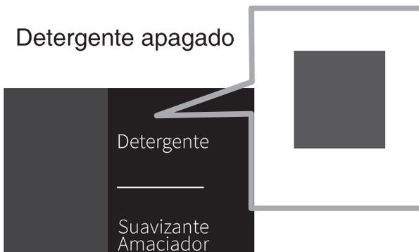
El detergente está desactivado y no se dosificará al final del programa. Esto es visible en la pantalla como en la imagen de abajo. No hay indicaciones LED.
