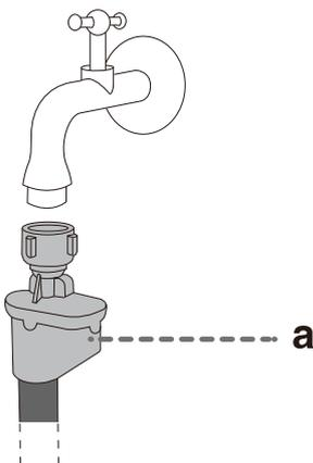
⚠ No sumerja la manguera de suministro de agua con el sistema Tope de agua en agua, ya que contiene una válvula eléctrica.
