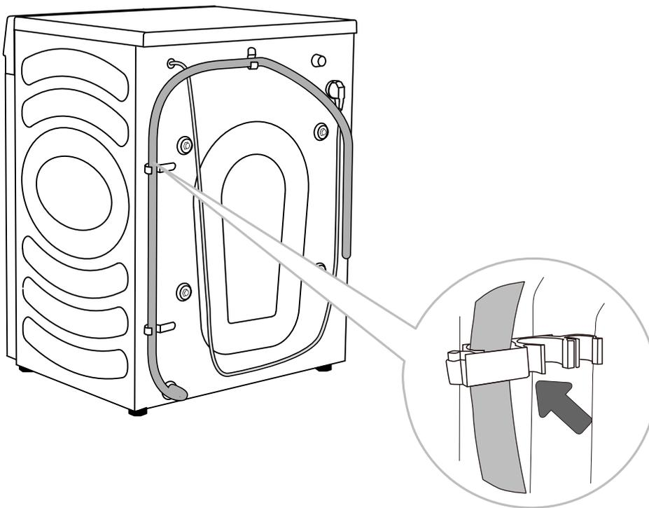
**D** La manguera de descarga debe conectarse y fijarse en el pasador situado en la parte posterior de la lavadora, tal y como se muestra en la figura. La longitud máxima de la manguera de drenaje es de 1,65m.
