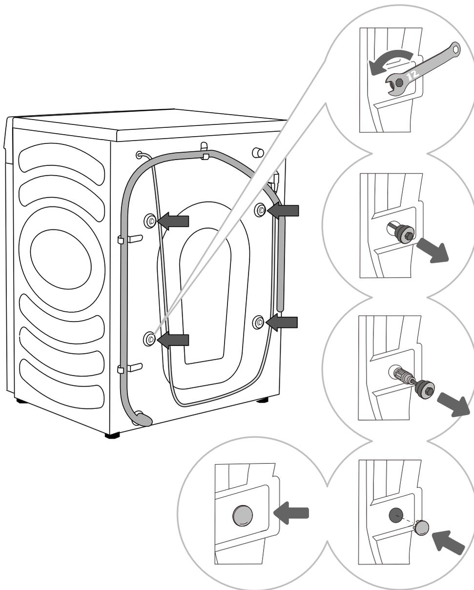
**1** Aparte las mangueras y utilice una llave de montaje para girar los 4 tornillos de la parte posterior del aparato en el sentido antihorario, tal y como indican las flechas. Afíjelos unos 30mm (no completamente).
