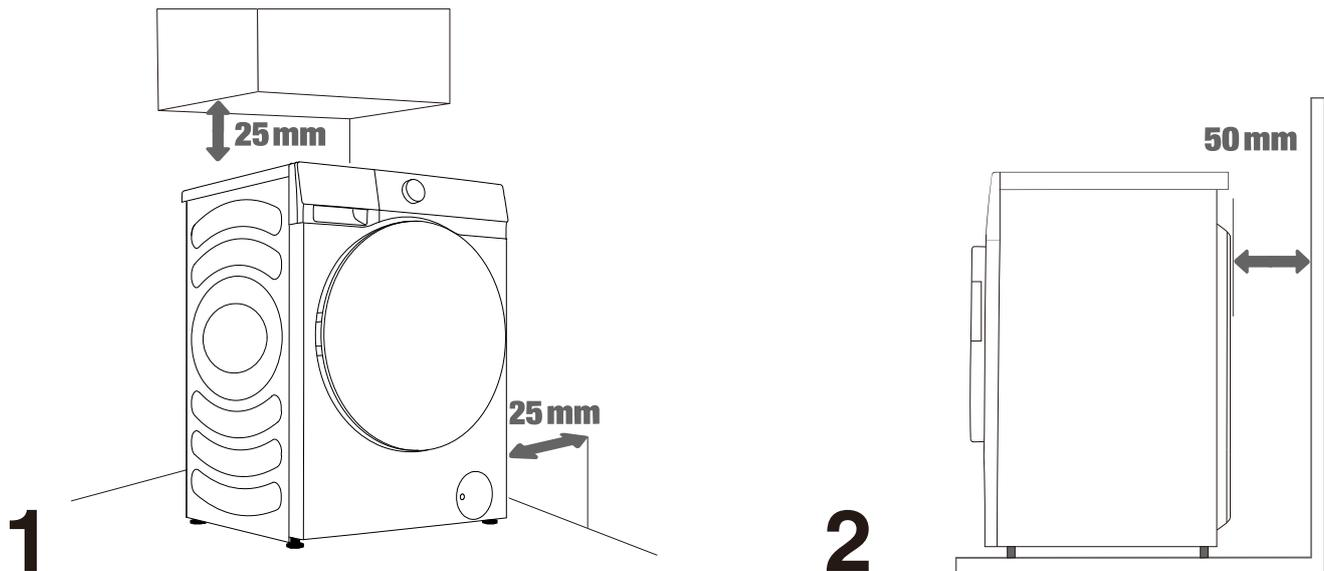
⚠ La lavadora no debe entrar en contacto con paredes o muebles adyacentes. Para optimizar el funcionamiento de la lavadora, recomendamos seguir las distancias a la pared tal como se indica en la figura.
