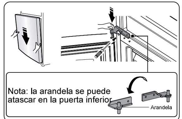
15. Mueva la puerta superior a una posición adecuada y, a continuación, fije la pieza ② con tornillos ①. Antes
