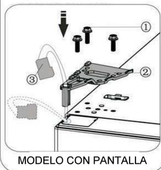
16. Conecte un conector eléctrico ① como se muestra en la imagen y, a continuación, fije la pieza ② con un tornillo ③. Consulte el paso 2.
