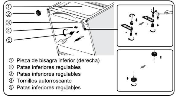
12. Quite la parte ③ desde la clavija de la bisagra inferior, afloje la clavija de la bisagra inferior, cámbiela en el orificio opuesto y ajústela; luego, instale la parte ③ en la clavija de la bisagra inferior.
