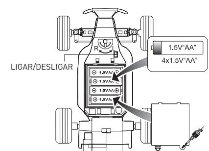
Com uma chave de fendas (não incluída), remova o parafuso e abra a tampa das pilhas na parte inferior do veículo. Insira / substitua as pilhas na unidade, com a polaridade indicada no compartimento das pilhas. Volte a colocar a tampa do compartimento das pilhas com o parafuso e a chave de fendas.
