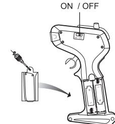
Com uma chave de fendas (não incluída), remova o parafuso e abra a tampa das pilhas no lado do comando remoto. Insira / substitua as pilhas na unidade, com a polaridade indicada no compartimento das pilhas. Volte a colocar a tampa do compartimento das pilhas com o parafuso e a chave de fendas.
