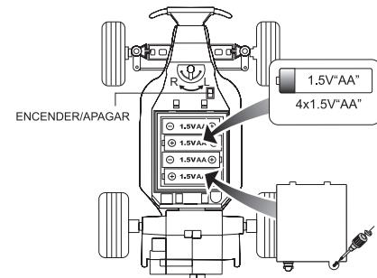
Afloja el tornillo con la ayuda de un destornillador de punta de estrella (no incluido) para abrir el compartimento de las pilas situado en la parte inferior del vehículo. Coloca / sustituye las pilas en el compartimento dedicado a tal efecto y respetando el esquema de polaridad que se indica en la ilustración. Cierra el compartimento y atorníllalo de nuevo.
