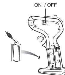
Afloja el tornillo con la ayuda de un destornillador de punta de estrella (no incluido) para abrir el compartimento de las pilas situado en el lateral del mando de radiocontrol. Coloca / sustituye las pilas en el compartimento dedicado a tal efecto y respetando el esquema de polaridad que se indica en la ilustración. Cierra el compartimento y atorníllalo de nuevo.
