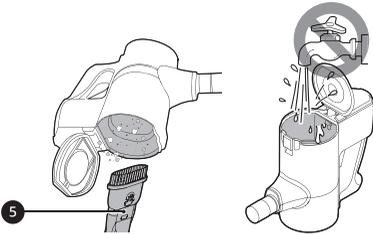
**7** Gire el cuerpo del producto y levante la palanca del Kompresor **6** para limpiar el interior de la placa de trabajo con el cepillo de limpieza suministrado.
