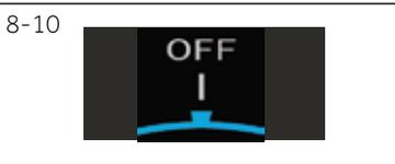
1. Gire el mando a la posición OFF para apagar la máquina (Fig. 8-10).
