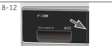
3. Vacíe el depósito de agua después de cada ciclo de secado (Imag. 8-12).
