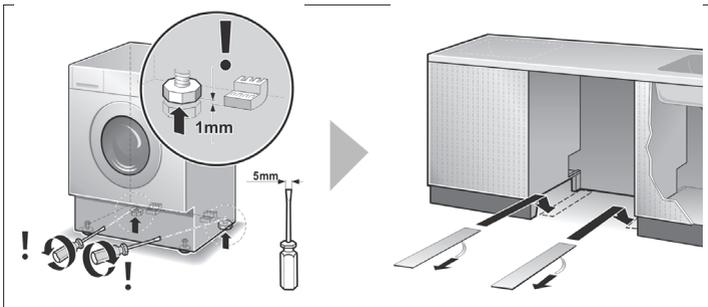
Las láminas deslizantes facilitan la introducción de la lavadora en el hueco de instalación.
