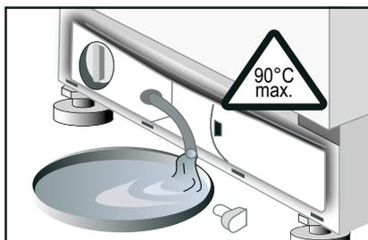
4. Desatornillar con cuidado la tapa de la bomba, puede salir agua residual. Limpiar la carcasa de la bomba y retirar cualquier objeto extraño. El propulsor de bomba de desagüe debe ser capaz de girar.
