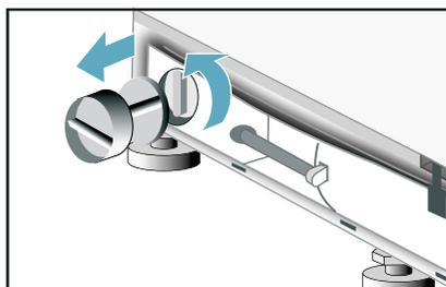
5. Volver a colocar la cubierta de la bomba y atornillarla bien en su sitio. Situar el panel protector en las 4 ranuras de enganche y fijarlo a la carcasa mediante los pasadores de bloqueo.
