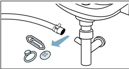
4. Conectar de nuevo la manguera de desagüe y fijar el punto de conexión utilizando la abrazadera.
