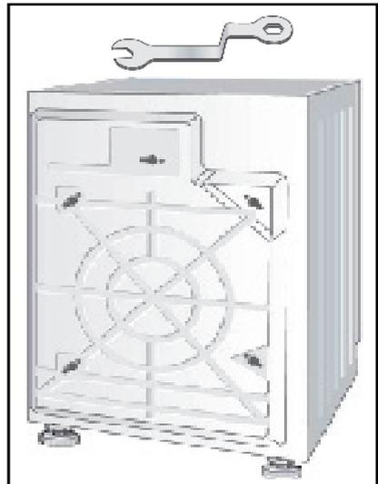
1. Desatornillar todos los tornillos con la llave de boca fija incluida.
