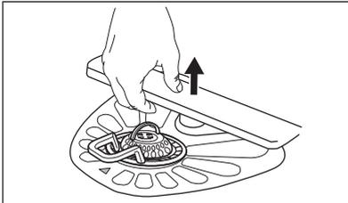
2. Lave el brazo aspersor bajo el agua corriente. Retire las partículas de suciedad de los orificios mediante un objeto afilado, como un palillo.
