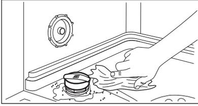
6. Gire la tapa del depósito de sal hacia la derecha para cerrar el depósito de sal.
