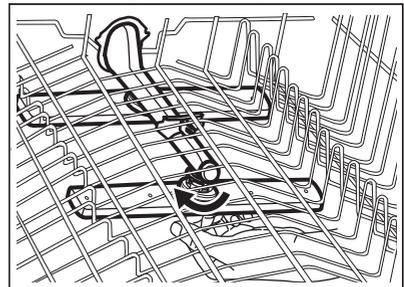
3. Lávelo con agua corriente. Retire las partículas de suciedad de los orificios mediante un objeto afilado, como un palillo.
