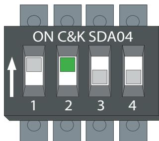
переключатель 2 → ВКЛ (ON) – Функция Bluetooth включена;
