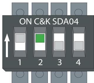
Przełącznik 2 → ON - komunikacja Bluetooth włączona
