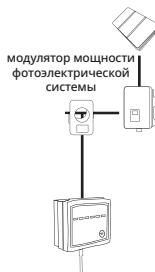
Кабель модулятора следует удлинить с помощью экранированного кабеля 2 x 1  $\text{mm}^2$  и подключить к электронному блоку зарядного устройства на клеммной колодке FOTOVOLTAICA («ФОТОЭЛЕКТР.»), как показано на рисунке:
