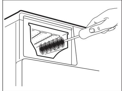
3. Enjuague el depósito de detergente bajo el grifo para eliminar los restos de detergente en polvo acumulados. Después de limpiarlo, vuelva a colocar la parte superior en su sitio.
