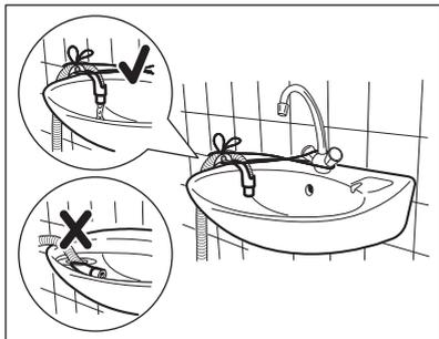
**i** Asegúrese de que el extremo de la manguera de desagüe no esté sumergido en el agua. Puede que vuelva agua sucia al aparato.
