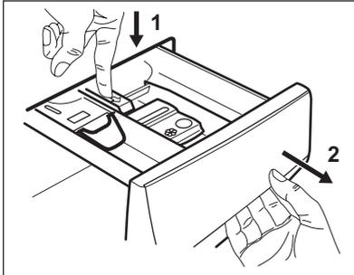
2. Retire la parte superior del compartimento de aditivo para facilitar la limpieza. Asegúrese de eliminar todos los restos de detergente de la parte superior e inferior del hueco. Utilice un cepillo pequeño para limpiar el hueco.
