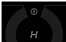
Después de usar una zona de cocción, puede permanecer caliente durante un rato. Mientras la zona de cocción permanece caliente, se muestra una "H" en la pantalla.
