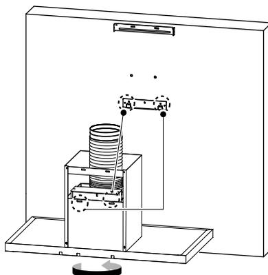
**6** Después de conectar el tubo de extracción con seguridad, fije el soporte de fijación de la chimenea con 2 **1** tornillos con tacos preparados para prevenir que el electrodoméstico se descuelgue accidentalmente del soporte de fijación de la campana.
