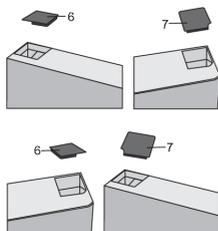
Retire la tapa. (6) desde el lado izquierdo de la puerta. Luego retire la tapa (7) desde el lado derecho de la puerta. Ponga la tapa (7) en el lado izquierdo de la puerta y coloque la tapa (6) en el lado derecho de la puerta.
