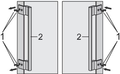
Retire los cuatro tornillos. (1) como se muestra en la figura. Gire el mango (2) 180° y reemplácelo en el lado opuesto. Luego, apriete los tornillos (1).
