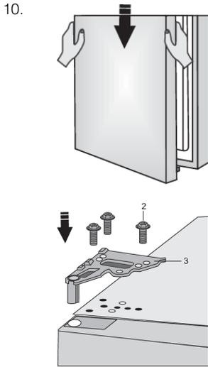
Coloque la puerta en la bisagra inferior y use los tornillos (2) para fijar la bisagra superior (3). Mantenga la puerta en su lugar mientras la coloca.
