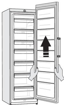
Retire la puerta de la bisagra inferior levantando cuidadosamente la puerta hacia arriba. Coloque la puerta sobre una superficie lisa.
