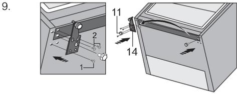
Fije la bisagra (14) en el lado opuesto, con los tornillos. Los tornillos deben colocarse en el orden que se muestra en la siguiente figura. Primero, ajuste el tornillo 1, seguido de los tornillos 2. Luego, atornille las patas ajustables (11).
