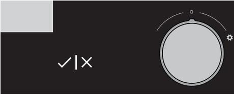
Gire la PERILLA PARA EL CAMBIO DE LA CONFIGURACIÓN (-/+ ) y en primer lugar ajustar los minutos, luego el tiempo muestra las horas. Luego de 3 segundos la configuración se guarda.
