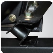
Base soporte para las vibraciones soporta el alternador y el motor
