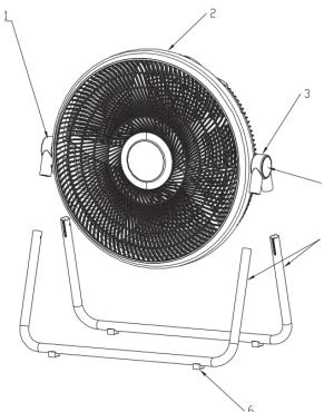
Inserte los dos extremos de los tubos en forma de U en los soportes izquierdo y derecho respectivamente.
