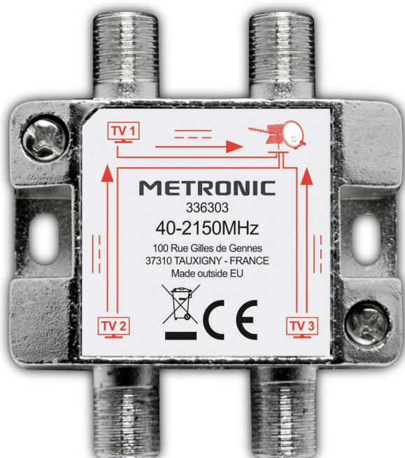
Sirve para distribuir señales TDT o satélite hacia 3 TV. En recepción satélite, en varias tomas (o TV), sólo se pueden recibir a la vez emisiones en la misma polaridad y misma banda de frecuencia. Se necesita un receptor digital por TV.
