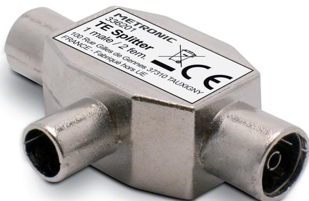
Repartidor en "T" blindado para conectar 2 tomas macho y una hembra de 9,52 mm entre sí. Garantiza el mantenimiento de la calidad de imagen en los 2 televisores, al tiempo que permite alimentar un amplificador de mástil.
