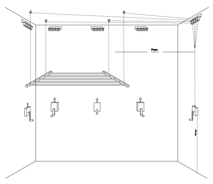
Instalación sobre paredes paralelas y perpendiculares, incluso con la posibilidad de dejar paso entre el tendedero y el mecanismo de subida.
